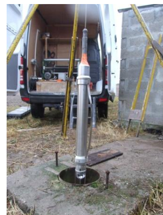
Inspection vidéo de l'ouvrage
