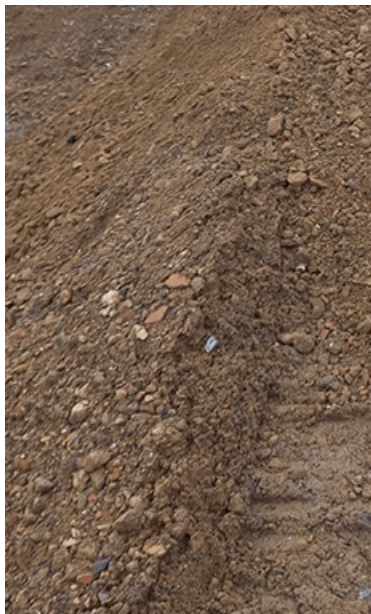
Béton recyclé, utilis remblai
